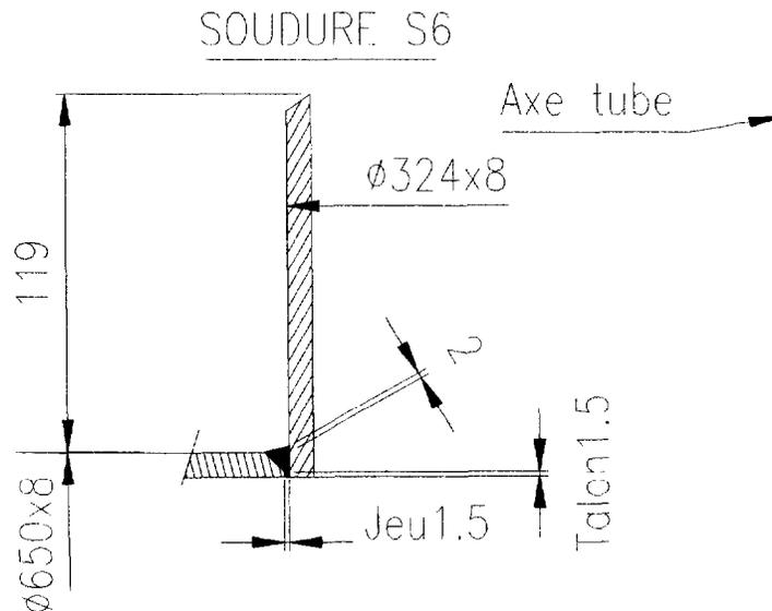
On envisage le traçage de la pénétration du piquage avec un gabarit d'épaisseur négligeable à présenter sur l'extérieur de la virole formée ( $D = 650 \text{ ext.}$ ). Ce gabarit devra comporter une courbe pour la découpe de la pénétration et une autre pour la limite extérieure du chanfrein d'angle constant. La découpe s'effectue parallèlement à l'axe de la virole de diamètre 324 x 8.
