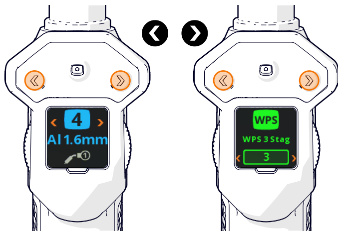
Illustration 24 : Affichage des canaux : canal mémoire et canal DMOS
