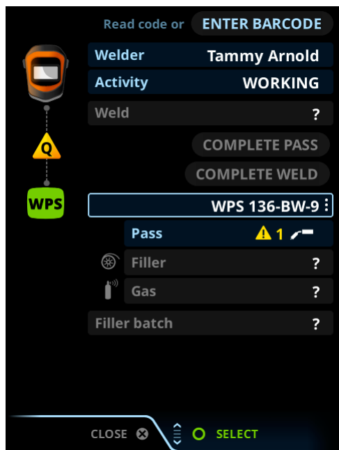
Illustration 52 : Le soudeur n'est pas qualifié pour souder avec le DMOS sélectionné
