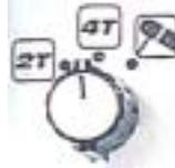
Ogni rotazione del pulsante seleziona un modo di saldatura.
