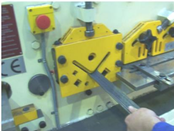
Cisaille à profilés pour le débit des fers en L(cornières), ronds et carrés
