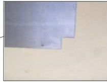
Grugeage en bord de tôle avec mise en butée
