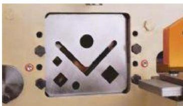
Cisaille à profilés pour le débit des fers en L(cornières), ronds et carrés
