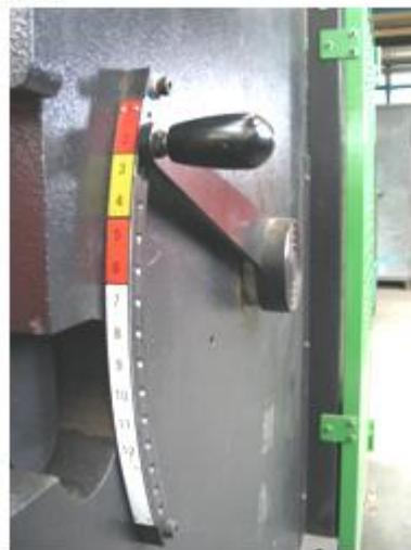
Le réglage de l'angle de coupe s'effectue grâce à un levier situé en face avant de la machine, le groupe hydraulique doit être en marche.
