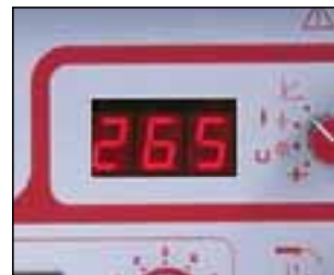
MIG Spray-Arc épaisseur < 10 mm.
