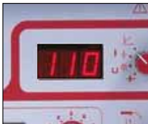
MIG Short-Arc épaisseur < 3,0 mm.
